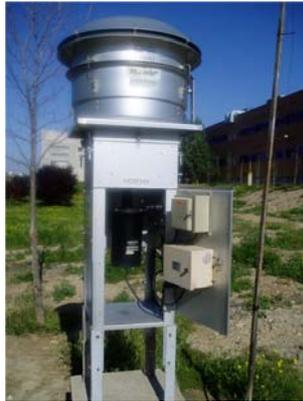
Muestreador de alto volumen, (Graseby Andersen GMW Model 1200) equipado con un cabezal de corte para materia particulada de diámetro aerodinámico de partícula menor o igual a 10 micras (PM10).
