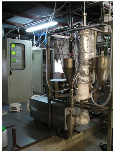
**Instalación experimental de oxidación de carbón en lecho fluidizado burbujeante.**
