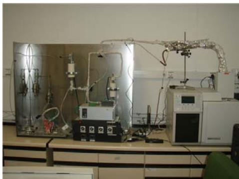
**Reactor de lecho fijo para realizar pruebas de oxidación catalítica de contaminantes orgánicos volátiles sobre carbones activados impregnados con diferentes catalizadores**
