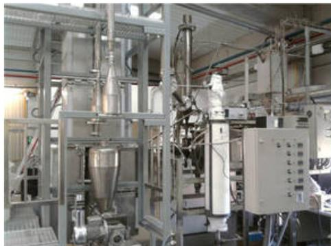
Planta piloto para Pirólisis y Gasificación de Biomasa o Neumático
